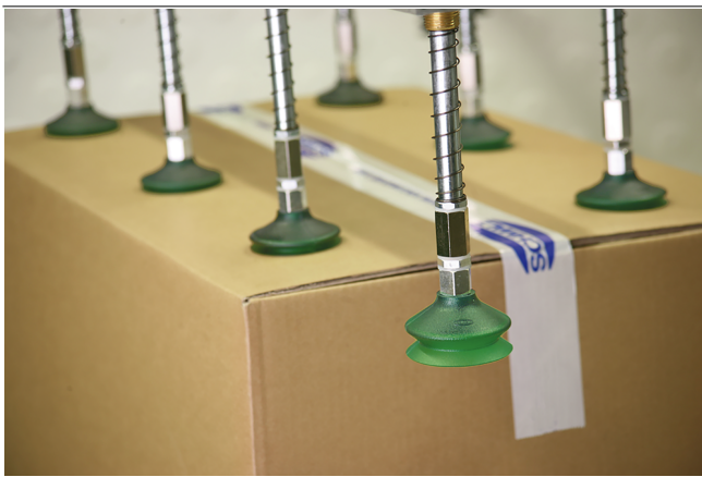
Сильфонные присоски FSGA VU1, используемые для перемещения картонных коробок
